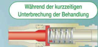
Das Rückschlagventil schließt automatisch, wenn der Konnektor (männlich) des Blutschlauchs entfernt wird und hilft dabei, das Auslaufen von Blut zu vermeiden.
