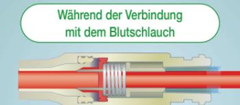
Das Rückschlagventil öffnet automatisch bei Verbindung mit dem Blutschlauch. Achten Sie darauf, dass die Sicherungsmutter des Blutschlauchs fest angezogen ist.
